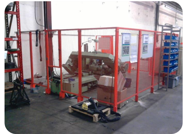
Scie automatique. Enceinte périmétrique avec un accès opérateur par porte battante et un passage pièce.
