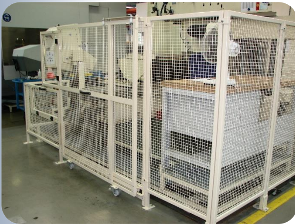
Machine automatique. Module porte coulissante avec contacteur électrique
