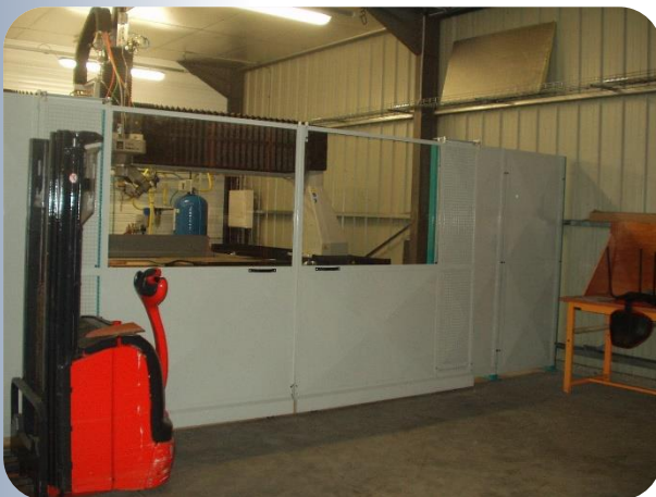
Machine de découpe à jet d'eau. 'Remplissage' des panneaux en partie basse en tôle et partie haute en verre.
