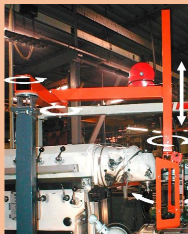
Trois axes de rotation + un réglage en hauteur
